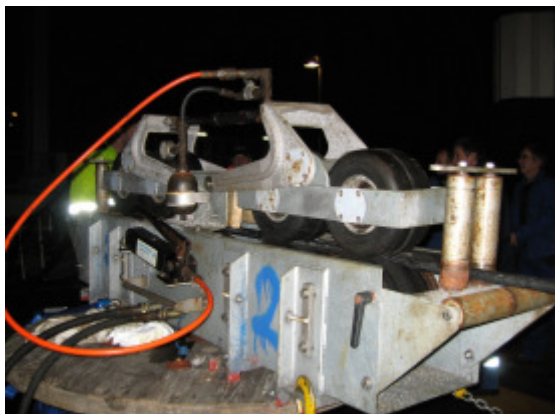
Bild 2: Die umgerüstete Bodensee-Fähre verfügte über eine Kabelvortrieb/-bremseinrichtung, damit das Kabel beim Herablassen auf den Seegrund gebremst werden konnte.
