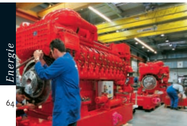
Montage eines 20V-4000-Feuerlösch-Aggregats.
