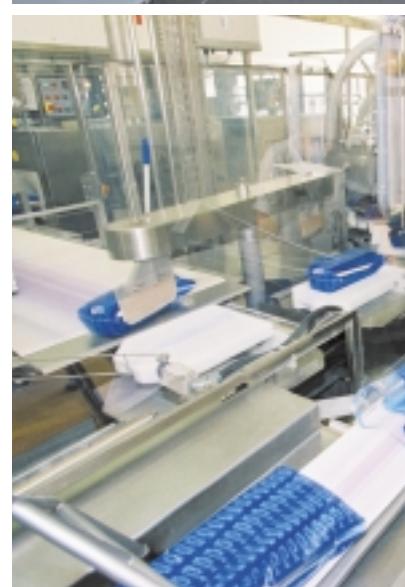
Nach dem Salzbad gelangt der Käse in Beutel, die unter Vakuum verschweißt werden.
