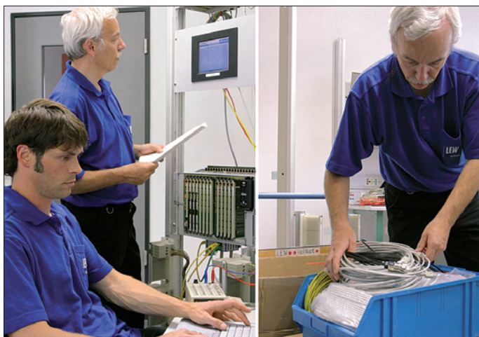
Das fertig aufgebaute und programmierte Fernwirkgerät wird in der Werkstatt von den Technikern M. Klimesch (vorn) und H. Schuster getestet und dann zur Montage verpackt
