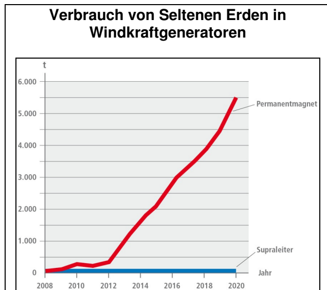
Grafik Verbrauch von Seltenen Erden in Windkraftgeneratoren; Quellen: Converteam: Bedarf für Direktangetriebene PM-Generatoren und Supraleiter-Generatoren; Zenergy Power: Bedarf für Supraleiter; Windkraftdaten von AMSC, EWEA und GWEC
